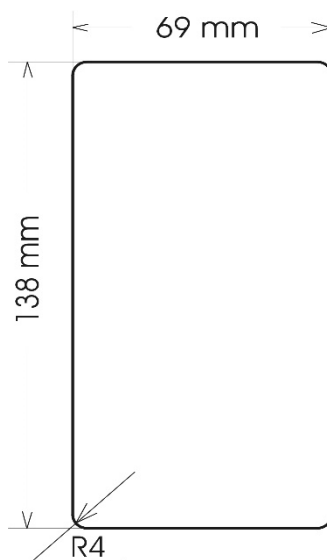
Рис. 8. Разметка под установку блока ВК-381ЛПД в щите.
