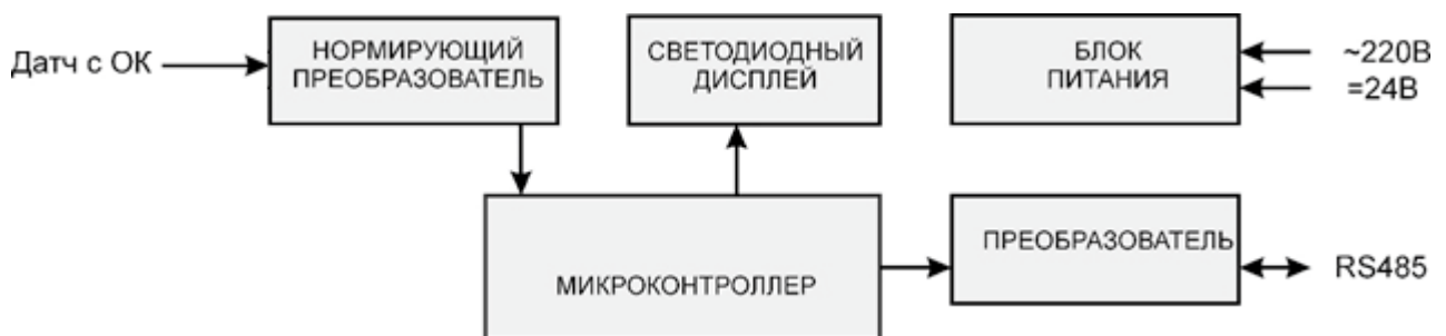
Рис. 12 Структурная схема выносного табло тахометра ВК-371ТД.
