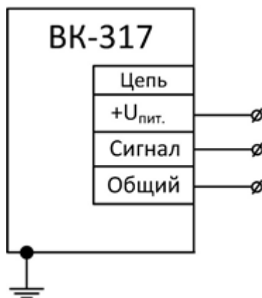
Рис. 13 Назначение контактов ВК-317, ВК-317-1 и ВК-317.01.
