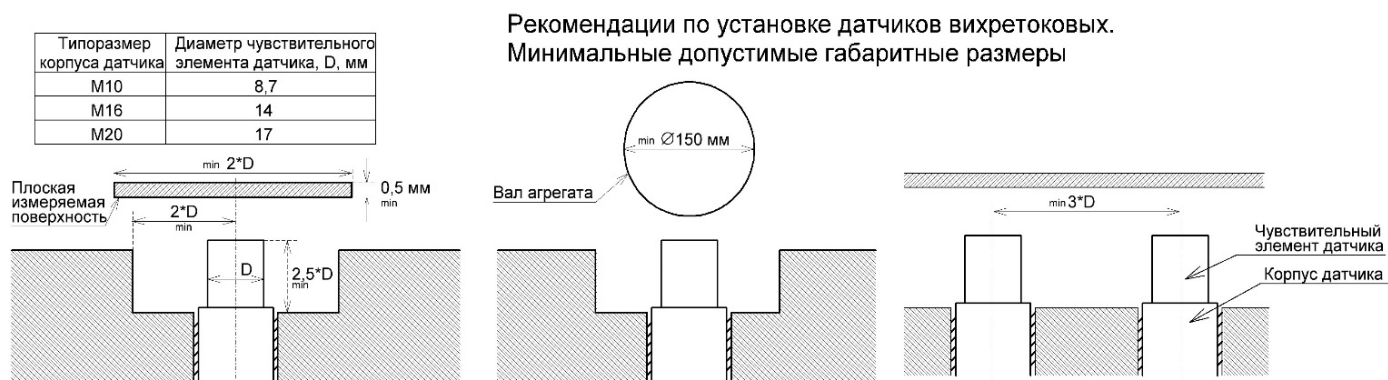
Рисунок 10 Рекомендации по установке ЧЭ вихретоковых датчиков
