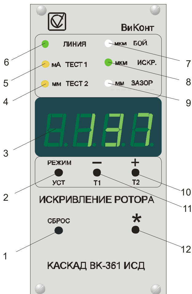
Рисунок 10. Внешний вид лицевой панели и назначение органов управления и индикаторов.
